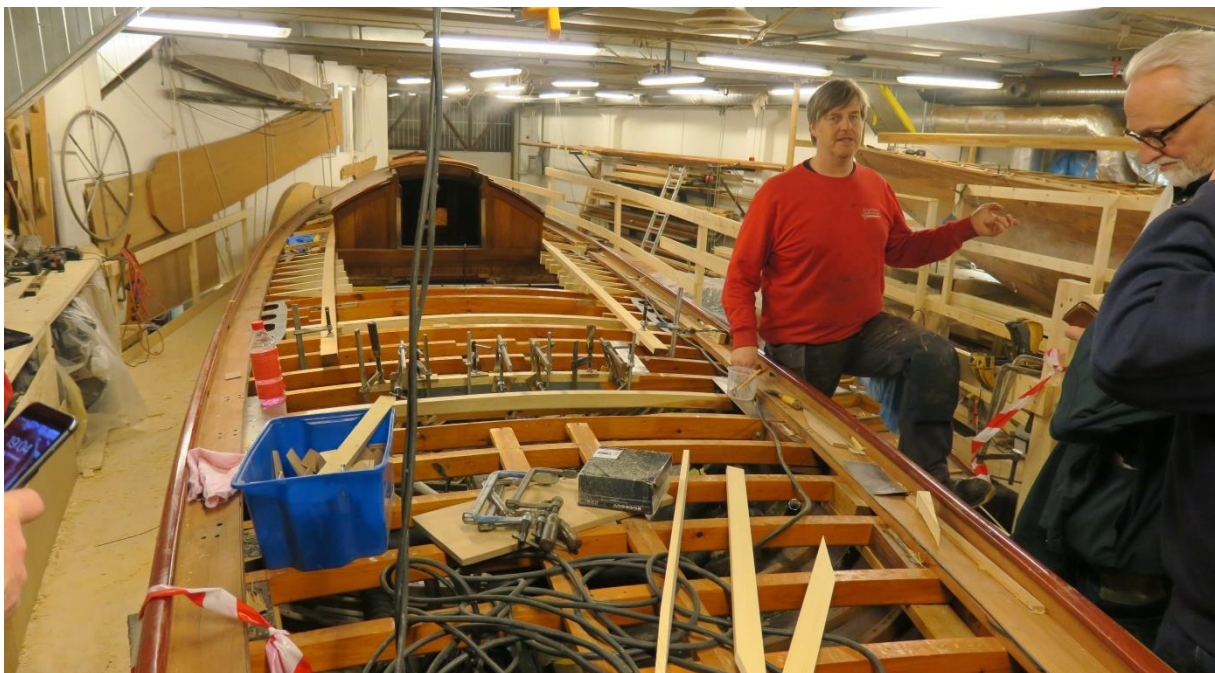
Andreas berättade också om att man håller på att lägga ett nytt, konat oregon pine-däck på skärgårdsnittiofemman Gerdny (bygg 1920). Sittbrunnen byggs också om och återställs till originalskick. Ratten (som hänger på väggen i bakgrunden) byts också ut mot en rorkult.
