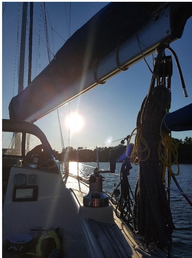
Storskotskenan, enkelt tillgänglig i sittbrunnen med sin travarjustering i ändstyckena på skenan. Självsående focken skotas på en av vinscharna på sargen.
